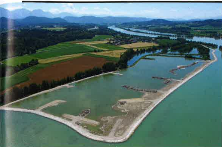
Bild 1 (linke Seite): Viele Fachbereiche fließen in die forstliche Planung ein, Bild 2 (oben): Drohnenfoto der „Brenndorfer Bucht“ – Maßnahmenumsetzung mittels 3D-Modell und GPS-gesteuertem Bagger
